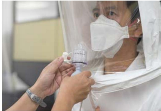
Hình 20: Một bộ dụng cụ kiểm tra độ khít của khẩu trang hiệu suất lọc cao.
