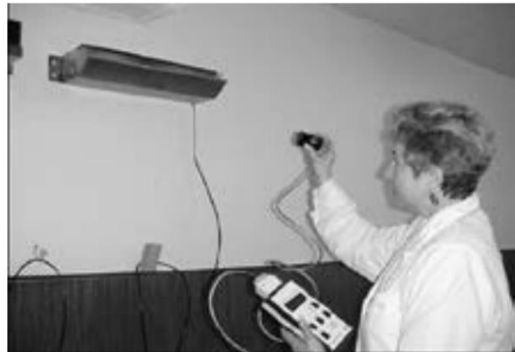
Hình 14. Đo hiệu suất của các GUV254 và Người thực hiện đo phải đeo kính bảo vệ mắt trong quá trình đo
